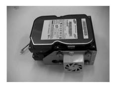
6. 内蔵HDDのHDDブラケットを元の場所に取り付けます。 製品底面の5つすべての取付け場所とHDDブラケットの取付け穴との位置をきちんと合せてHDDブラケットを置いてから、HDDブラケットを製品の外側方向にスライドさせ、ネジを留めます。
